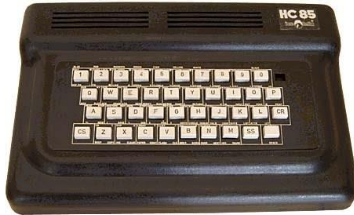
Microcalculatorul HC85. (1985) a fost proiectat și realizat ca model de laborator în Catedră și a fost introdus în fabricație la Intreprinderea de Calculatoare Electronice din Bucuresti.(A. Petrescu, I. Francisc)
