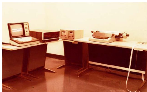
Microcalculatorul FELIX MC-8. (1975) bazat pe microprocesorul Intel 8008. A fost fabricat în producție de serie la Întreprinderea de Calculatoare Electronice din București. Premiul Academiei Române „Traian Vuia” pe anul 1975. (A. Petrescu, N. Țăpuș și T. Moisa)
