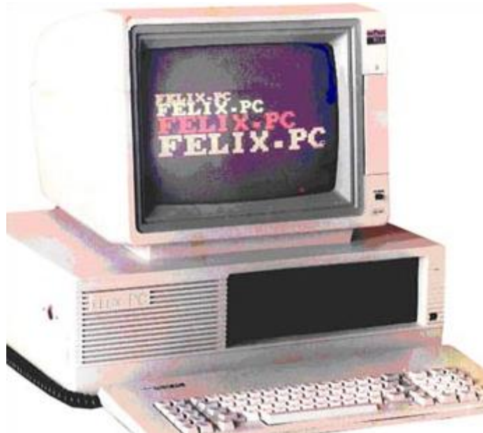
Microcalculatorul FELIX-PC. (1985) bazat pe Intel 8086, primul calculator de tip PC din România. A fost fabricat în producție de serie la Întreprinderea de Calculatoare din București. (A. Petrescu, N. Țăpuș, T. Moisa, I. Athanasiu)
