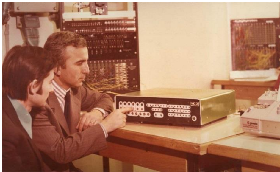
Microcalculatorul MC-1. (1973) destinat achiziției și prelucrării datelor în stațiile de distribuție a energiei electrice Petrescu, N. Țăpuș, T. Moisa).
